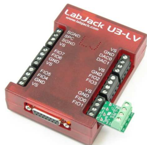
Esempio di accessorio per leggere una termocoppia
